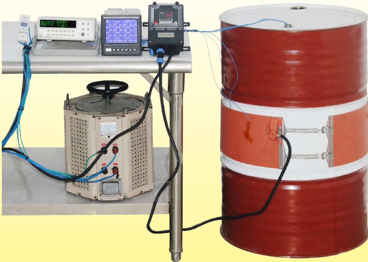
Variación de la temperatura versus el tiempo de un tambor de metal de 220 litros, **lleno de agua**, calentado por una cinta calefactora de silicona de 200 mm de ancho, sin aislamiento térmico, potencia de **1500 W** (carga superficial de **0,5 W/cm<sup>2</sup>**).
