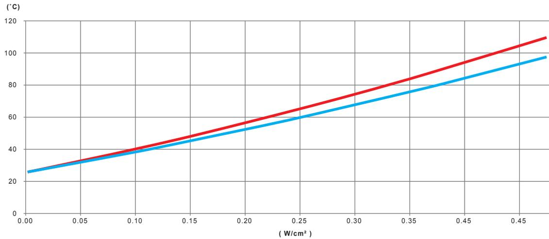
Variación, en función de la potencia en W/cm<sup>2</sup> de la cinta calefactora de silicona, de la temperatura de la pared de un tubo de acero inoxidable lleno de agua no circulante, aislado térmicamente con 20 mm de espuma de PVC-NBR
