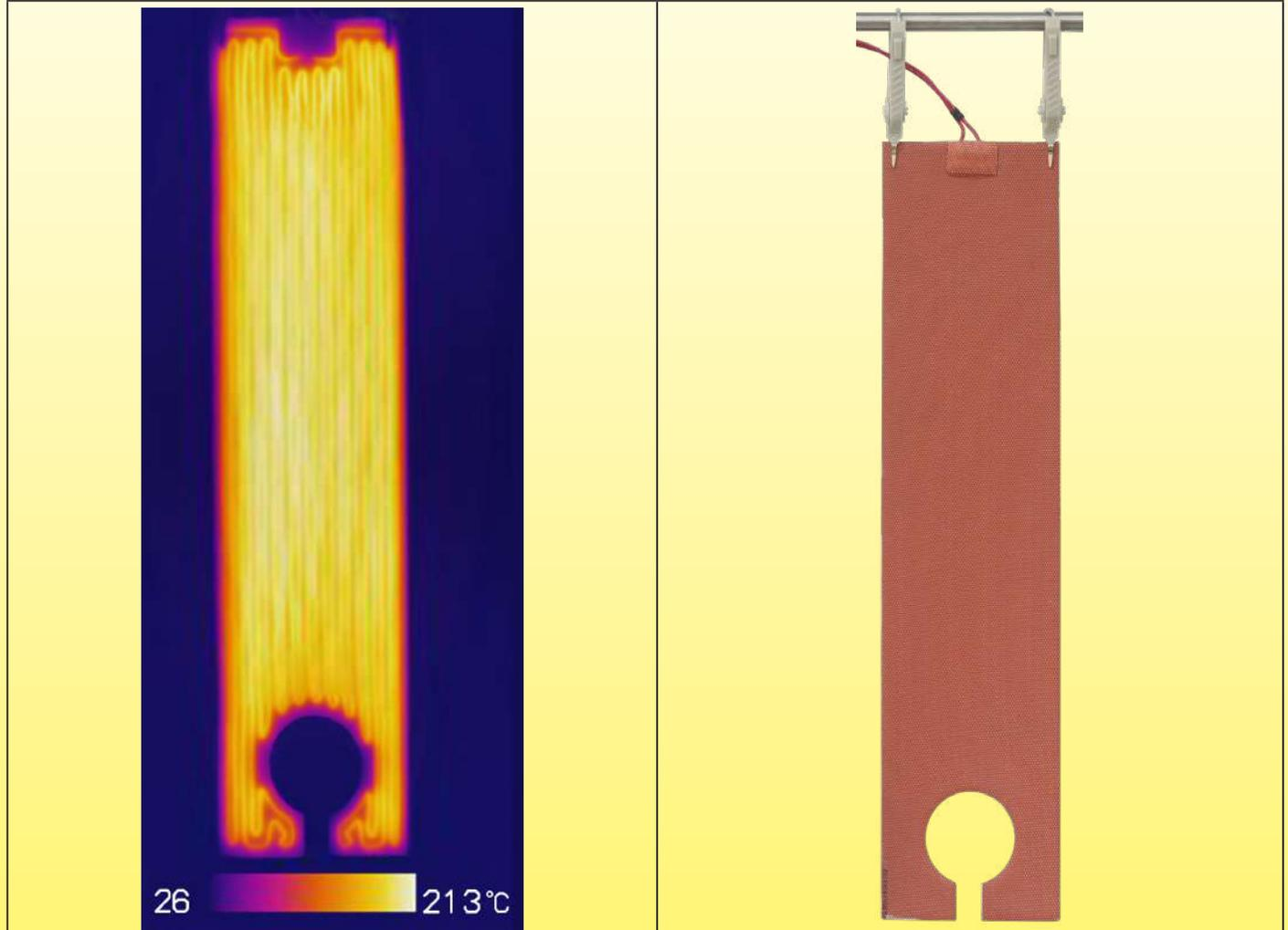
Imagen termográfica de una cinta calefactora de silicona plana de 2,4 mm con una carga de potencia superficial de  $1 W/cm^2$ , suspendida en aire tranquilo, no fijada en una placa, a una temperatura ambiente de  $25\text{ }^\circ\text{C}$ . La temperatura superficial alcanza los  $213\text{ }^\circ\text{C}$ , cerca de su destrucción.
