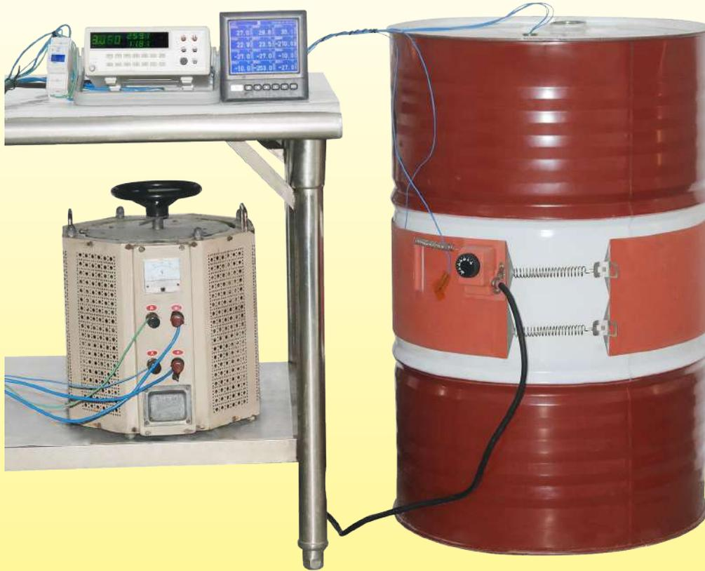
Variación de la temperatura versus el tiempo de un tambor de metal de 220 litros, **lleno de agua**, calentado por una cinta calefactora de silicona de 200 mm de ancho, sin aislamiento térmico, potencia de **2250 W** (carga de potencia superficial de **0,75 W/cm<sup>2</sup>**).
