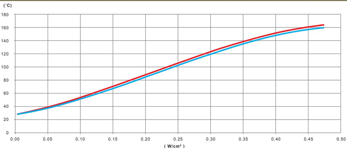
Variación, en función de la potencia en W/cm<sup>2</sup> de la cinta calefactora de silicona, de la temperatura de la pared de un tubo de acero galvanizado vacío, aislado térmicamente con 20 mm de espuma de PVC-NBR
