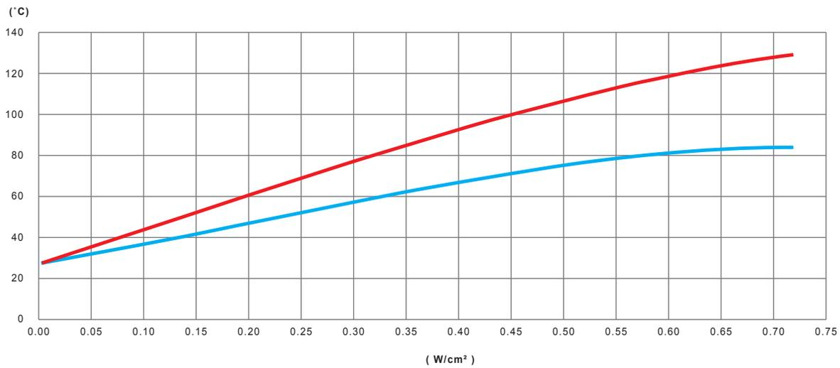
Variación, en función de la potencia en  $W/cm^2$  de la cinta calefactora de silicona, de la temperatura de la pared de un tubo de PVC lleno de agua no circulante, no aislado térmicamente
